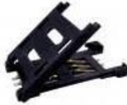
شکل ۲- قاب سیم کارت دستگاه تانسیومتر خاک هوشمند
